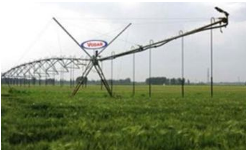
Рис. 4.9. Оросительная машина VODAR с одинарным пролётным корпусом и водным приводом
