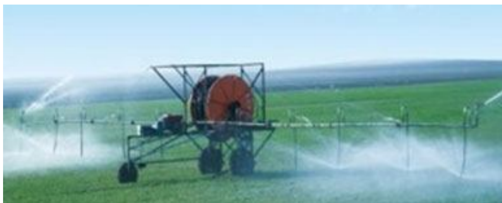
Рис. 4.28. Малогабаритная фронтальная оросительная машина VODARc самообеспечиваем водой и электричеством
