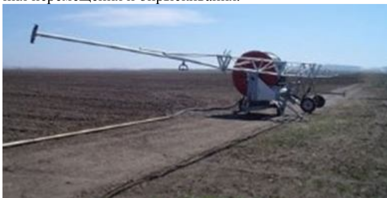
Рис. 4.37. Консольная оросительная машина типа JP65-JP-100 со многими распылительными головками.
