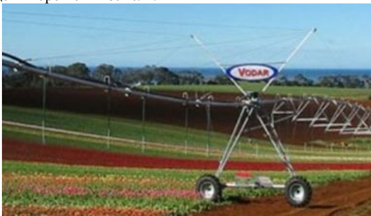
Рис. 4.30. Оросительная машина VODAR с одинарным пролетным корпусом и двигателем.
