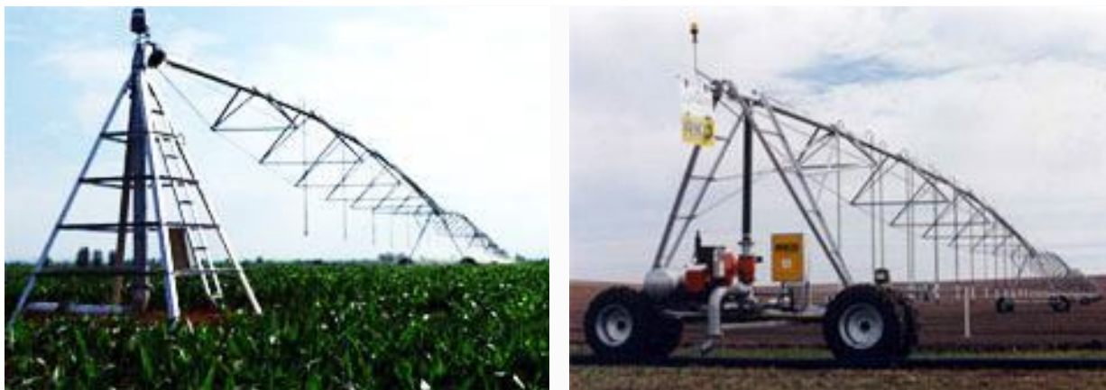
Рис. 4.64. Центральная опора дождевальной машины и опора фронтальной машины
