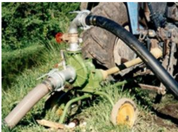
Рис. 3.12. Насос подключен к валу отбора мощности трактора
