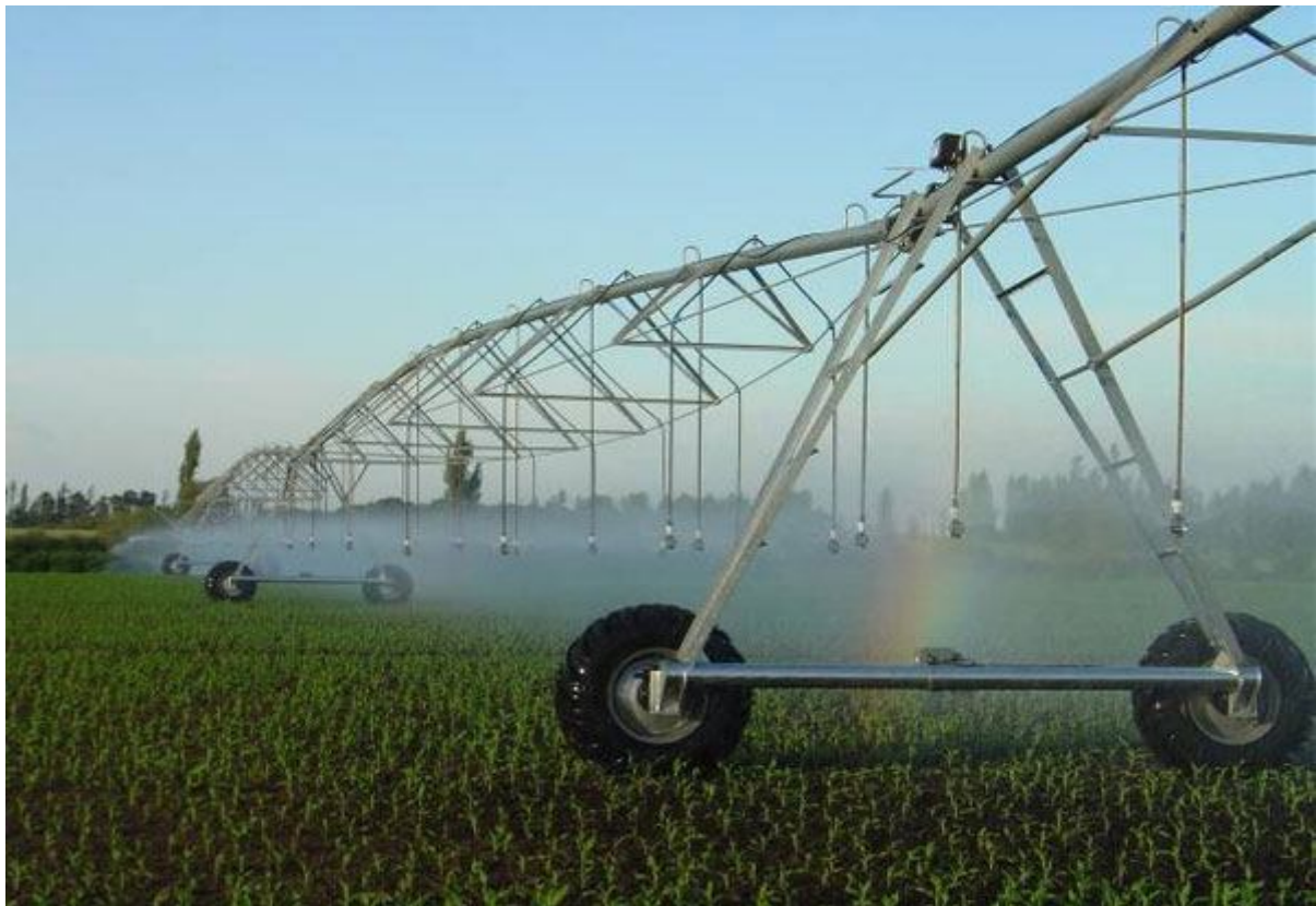
Рис. 4.60. Работа круговой ДМ RKD с фиксированным центром
