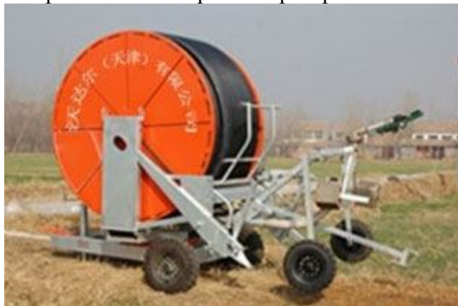
Рис. 4.38. Оросительная машина типа JP65-JP-100 с одиночной распылительной головкой и шланговой катушкой
