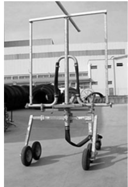
Рис. 4.33. Конструктивная схема элементы крепления консоли – Spray Boom Высота до труб А = 1,2 м, Изменяемая ширина колеи В = от 1,4 м до 1,80 м, Ши- рина 44 м, Ширина полива 50 м.
