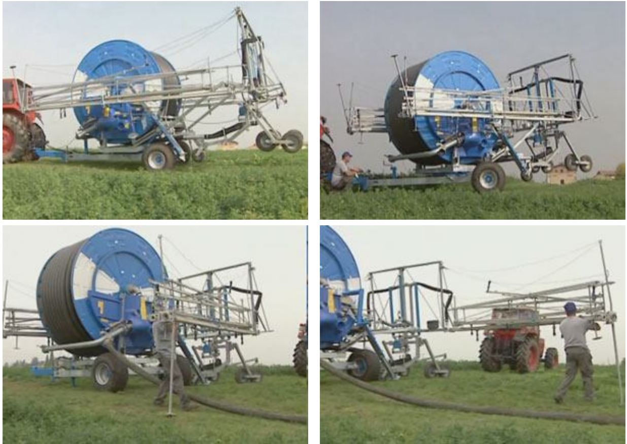
Рис. 4.34. Консоль в транспортном положении и фрагменты ее раскладки
