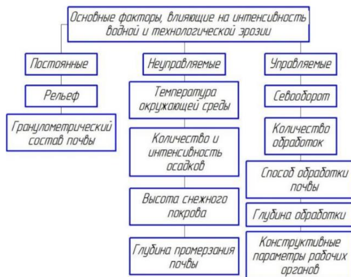
Рисунок. Основные факторы, влияющие на интенсивность водной и технологической эрозии
