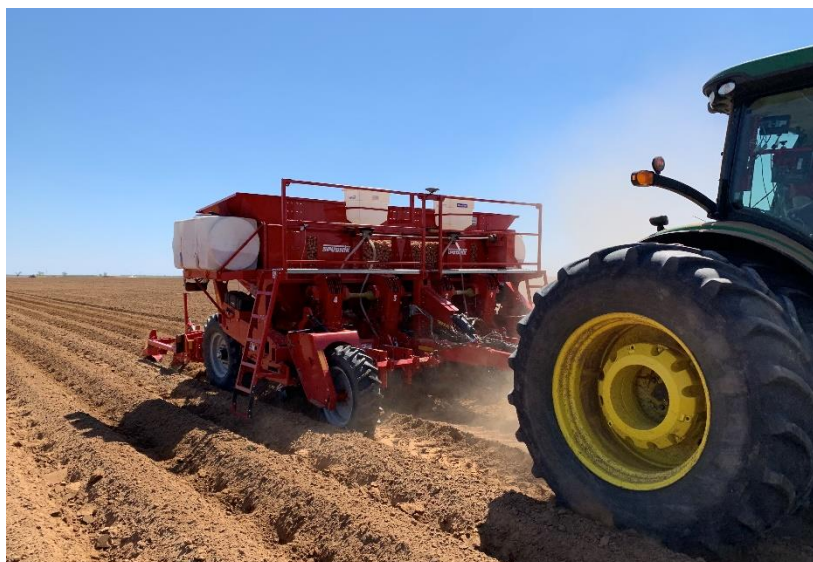
Рис. 1. Картофелесажалка Spudnik 8040 с приспособлением для внесения гранул «Horstain farmery».
