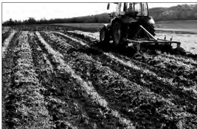
Рис. 2. Гребнекульная обработка орудием противозероэрозийным ОП-3С.
